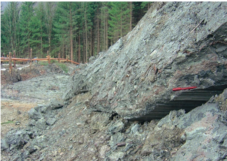
Fig. 5: Scherfläche innerhalb der feinkörnigen Verwitterungsderivate des Ultrabaselvikums mit einer deutlich bewegungsorientierten (E-W) Striierung (Foto: G. MOSER, 2008). Shear plane inside the fine-grained weathered Ultrabaselvikum with a surface clearly affected by the direction of motion (photograph: G. MOSER, 2008).
